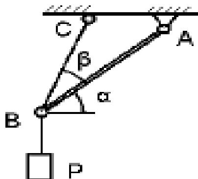
2. Груз весом  $P = 10$  Н подвешен на двух тросах AB и BC, составляющих с горизонтальной прямой углы  $\alpha=15^\circ$  и  $\beta=30^\circ$ . Определить усилия в тросах.
